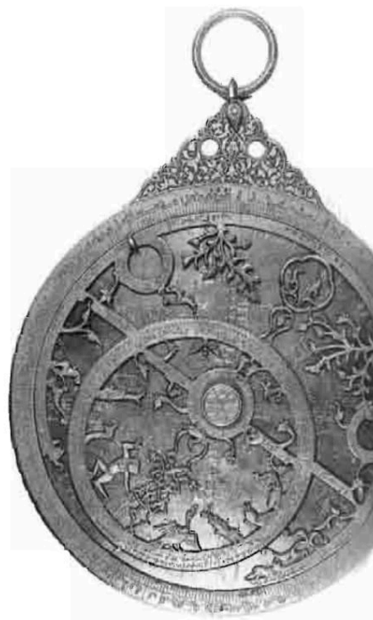
Thiết bị đo thiên thể sản xuất tại Cairo năm 1236 bằng đồng thau có chạm trổ bạc và đồng. Thiết bị này được các nhà thiên văn học và chiêm tinh học Hồi giáo sử dụng rộng rãi.
